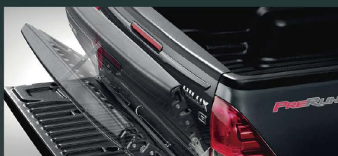
Asistente de Apertura y Cierre de Compuerta Trasera
